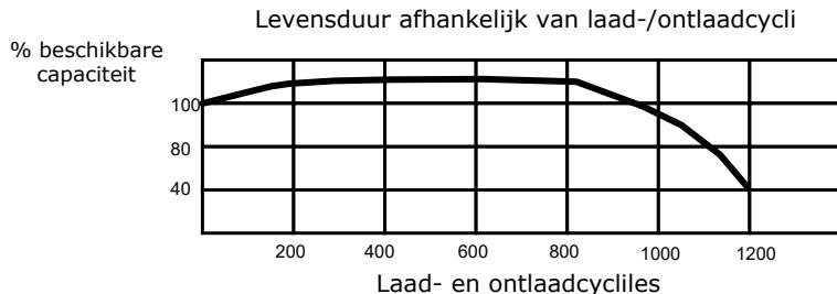
De laadcapaciteit van de oplaadbare batterij in deze schaal neemt af met het aantal laad-/ontlaadcycli, hierdoor wordt de levensduur beperkt tot 1000 cycli. Om deze reden is de garantieperiode van de batterij beperkt tot zes maanden na de aankoopdatum van de weegschaal.
