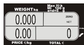
3.- Verwijder de verpakking en plaats de suiker erin. Wanneer u de verpakking verwijdert, verschijnt een negatief getal (gewicht van de verpakking) in de BOVENSTE-LINKER-display.
