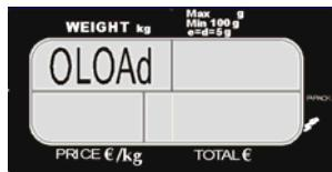
Diese Meldung zeigt an, dass ein Gewicht, welches die maximale Leistungsfähigkeit übersteigt, auf die Waage gestellt wurde. Korrigieren Sie dies, indem Sie das Übergewicht entfernen.
