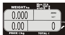
3.- Nehmen Sie das Behältnis von der Waage und füllen Sie ihn mit dem Zucker. Nehmen Sie das Behältnis herunter erscheint eine negative Zahl (Gewicht des Behältnisses) auf der Anzeige OBEN-LINKS.
