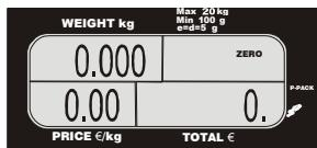
Ist dies nicht der Fall, beziehen Sie sich auf den Abschnitt Null. Stellen Sie dann das zu wiegende Produkt auf die Platte und Sie sehen das Gewicht in der entsprechenden Anzeige.
