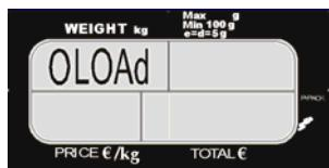
Ce message indique qu'un poids qui dépasse la capacité maximale a été placé sur la balance. Pour corriger cela, retirez simplement le poids en excès.
