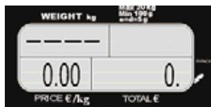
Diese Meldung zeigt ein negatives Gewicht an, dies kann vorkommen, wenn Sie die Platte der Waage anheben oder entfernen. Um dies zu korrigieren, bringen Sie die Platte zurück in deren
