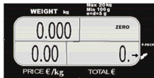
Deze pijl geeft aan dat de AC/DC-adapter op de weegschaal is aangesloten op de 220 VCA
